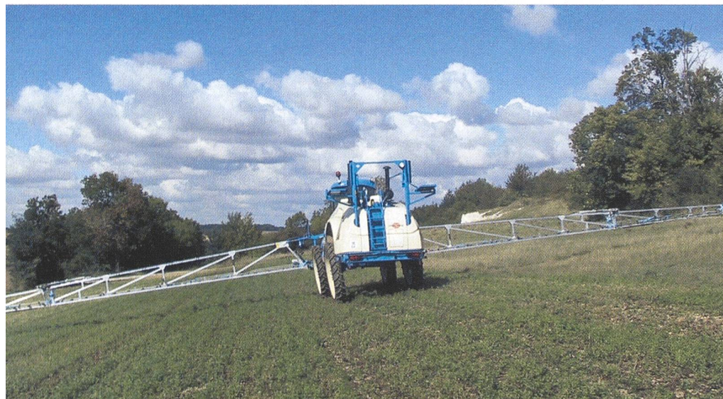
Pulvérisateur équipé du système «Stabilis».
