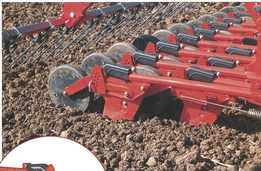
Semoir équipé des socs à cascade «Accura».
