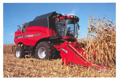
latéraux et le dispositif de coupe sont actionnés par le moteur au moyen d'une transmission en continu entraînée par un seul arbre de transmission.
