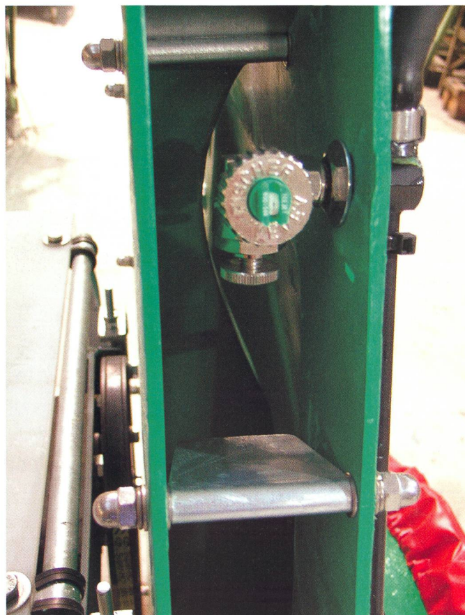
Fig. 5: Le réglage des déflecteurs permet de diriger le flux d'air et d'assurer ainsi une protection optimale du végétal.
