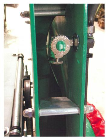
Fig. 5: Le réglage des déflecteurs permet de diriger le flux d'air et d'assurer ainsi une protection optimale du végétal.
