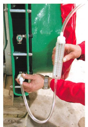
Fig. 3: L'utilisation d'un débitmètre facilite le contrôle du débit de chaque buse. (Ces documents ont été mis à disposition par Fischer.)
