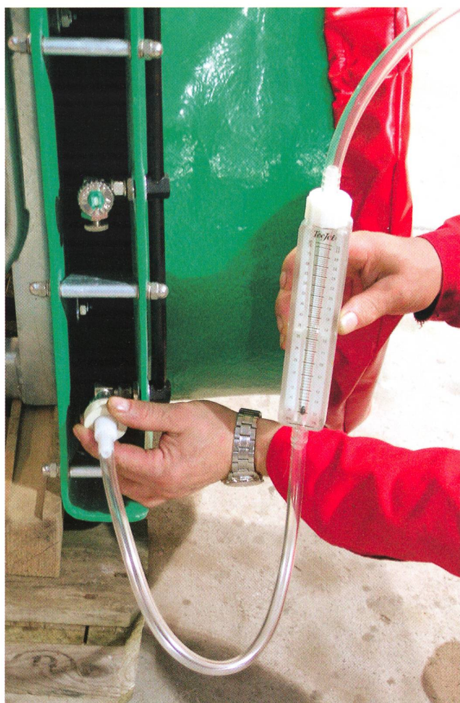
Fig. 3: L'utilisation d'un débitmètre facilite le contrôle du débit de chaque buse. (Ces documents ont été mis à disposition par Fischer.)
