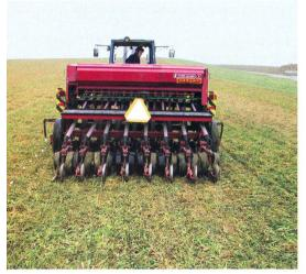
Le semoir à disques demande une puissance de traction réduite.
