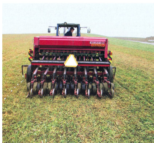
Le semoir à disques demande une puissance de traction réduite.
