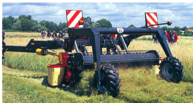
Vicon propose son conditionneur intensif avec brosse et rouleau à peignes en version traînée (KM 3001 HPC), un appareil bien adapté pour la récolte d'ensilage préfané sans utiliser la pirouette.
