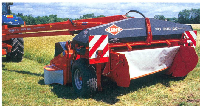
La faucheuse à disque traînée Kuhn FC 303 à timon d'attelage articulé et centré qui permet de manœuvrer aisément. Le conditionneur intégré est muni de fléaux pendulaires en acier.
