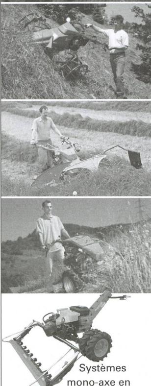
Systèmes mono-axe en différentes classes de grandeur, avec entraînement hydrostatique, poignée tournante et accessoires pour toutes saisons et toutes tailles d'exploitation.
