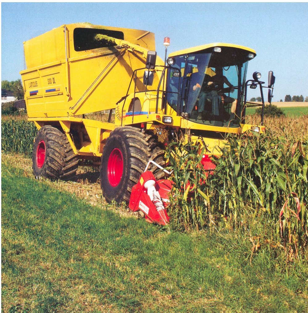
Ensileuse à bunker: indépendante du transport grâce à ses propres capacités de transport et la combinaison avec un système de bennes basculantes.
