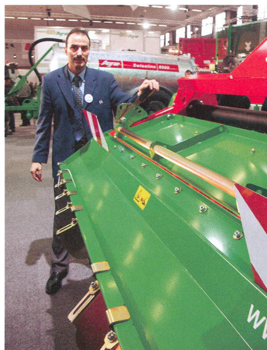
Daniel Stahl, directeur de la succursale de Flawil, SG: «A Flawil, des conditionneuses particulièrement efficaces grâce à leurs dents disposées individuellement et à leur surface striée variable sont assemblées.»
