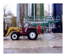
Largeur de travail: 9.0 m Nombre de pendillards: 36 Principe de fonctionnement:
