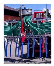
Largeur de travail: 8,4 m Nombre de pendillards: 28 Principe de fonctionnement: buse rotative Poids: 610 kg Raccordement hydraulique: 2 DW Accouplement: triangle d'attelage «Accord»/cat.2 Equipement de la machine testée: système combiné, tant pour la citerne que pour purinage par tuyaux, stop-goutte Prix catalogue: CHF 13 500.-
