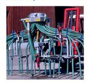
Largeur de travail: 9,2 m Nombre de pendillards: 36 Principe de fonctionnement: disque perforé horizontal Poids: 560 kg
