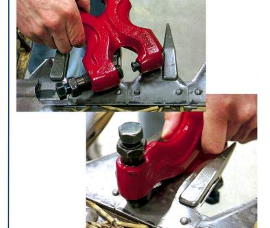
En deux temps trois mouvements: extraire le rivet, remplacer le couteau et fixer le rivet.
