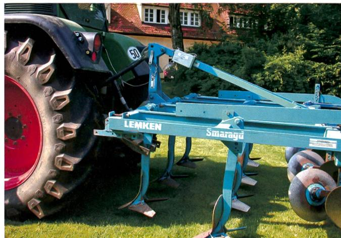
Le IMI est visible derrière le bras supérieur côté machine (détecteur d'outils sans ordinateur de bord).
