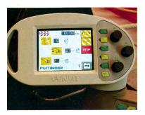
Le terminal montre au conducteur les valeurs de réglage de l'outil porté équipé d'un ordinateur de bord.
