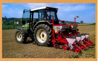
Semoir équipé pour une fumure sous-pied lors de la mise en place de l'essai. (Photo: Ursula Heiniger, Strickhof)
