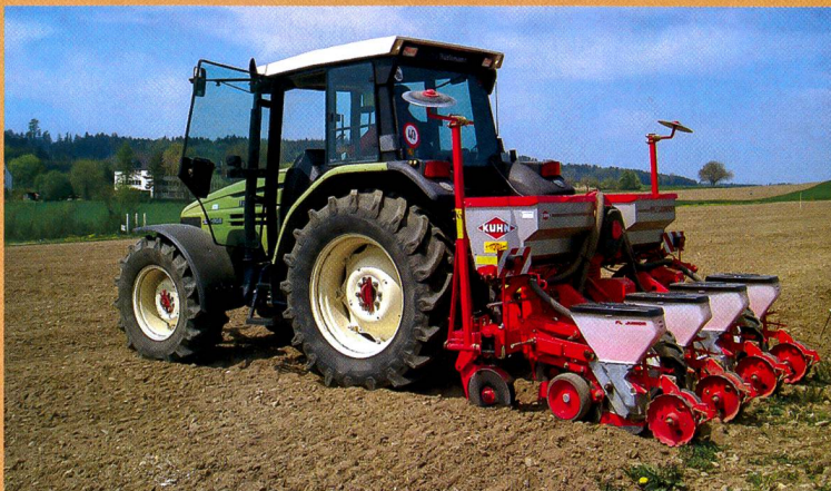
Semoir équipé pour une fumure sous-pied lors de la mise en place de l'essai. (Photo: Ursula Heiniger, Strickhof)
