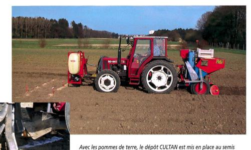
directement. Le tank avec la pompe contenant la solution de fumure respectivement le lisier concentré se trouve à l'avant du tracteur. L'injecteur est placé juste avant le soc de mise en place.
