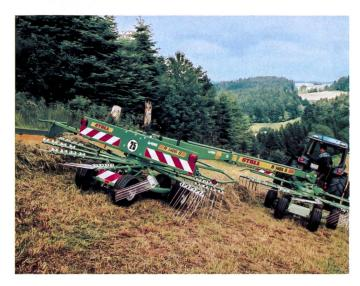
Les andaineurs doubles rencontrent un intérêt croissant, le rapport prixperformances devant cependant convenir. La fixation par cardan des toupies, le train roulant à voie large et pneus ballons, un châssis avec roues articulées, un guidage réglable de la position en rotation et une largeur variable de l'andain constituent des éléments standards des andaineurs à dépose centrale modernes.
