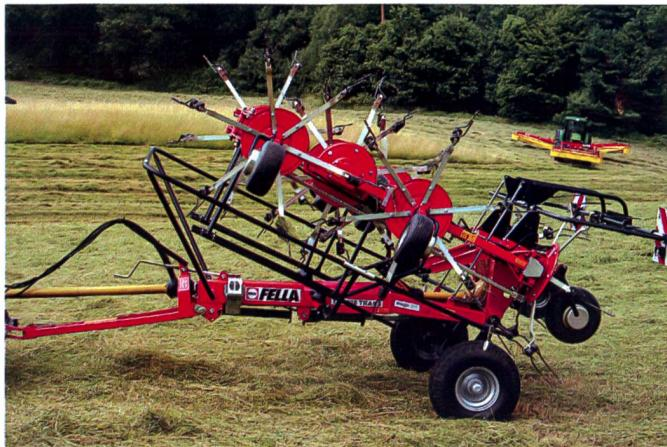
*La pirouette en six parties pour attelage au relevage hydraulique trois-points devrait convenir à la plupart des exploitations à l'avenir également. Un système de guidage, une parfaite adaptation au sol grâce à des articulations et des roues ballons, un dispositif central d'orientation pour le fanage en bord de champ, ainsi qu'un repli hydraulique des bras des toupies caractérisent les pirouettes actuelles.*
