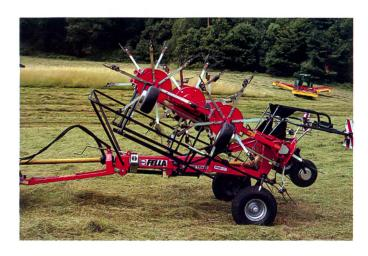
La pirouette en six parties pour attelage au relevage hydraulique troispoints devrait convenir à la plupart des exploitations à l'avenir également. Un système de guidage, une parfaite adaptation au sol grâce à des articulations et des roues ballons, un dispositif central d'orientation pour le fanage en bord de champ, ainsi qu'un repli hydraulique des bras des toupies caractérisent les pirouettes actuelles.
