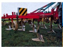
Le cultivateur à dents rigides, munis de socs à ailettes relativement plates, réalise un ameublissement efficace et homogène de la terre à profondeur moyenne.
