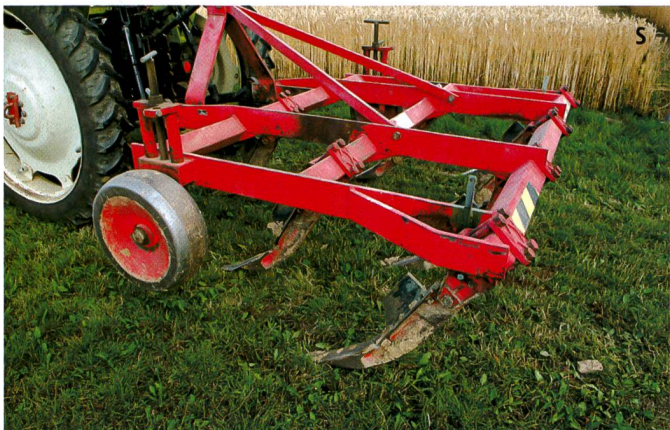
Le chisel permet de décompacter le sol jusqu'à la semelle de labour.
