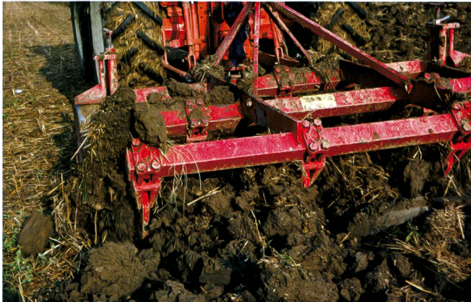
Le chisel incorpore la matière organique dans tout le profil travaillé. On lui préfère, actuellement, le décompacteur qui, lui, ne mélange pas les couches de terre.
