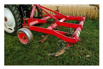
Le chisel permet de décompacter le sol jusqu'à la semelle de labour.
