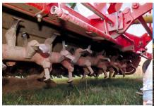
La herse rotative est une des machines permettant de réaliser le «travail minimum». Le semoir y est généralement directement accouplé; le semis est ainsi simultané.
