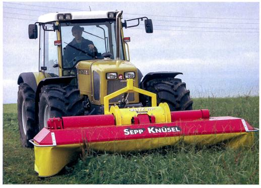
Small is beautiful... et tout de même: 120 CV sous le capot. La grille du radiateur à l'avant et sur les côtés laisse l'air circuler assez lentement. Les différents refroidisseurs sont disposés en forme de U, un concept breveté par Sepp Knüsel.
