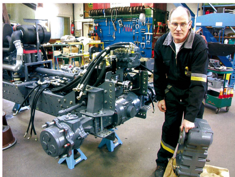
Phase finale de montage du deuxième tracteur. Sepp Knüsel place la transmission avant (conçue par lui-même) dans la bonne position. Reconnaissable, le milieu, le châssis animé (photos U. Zweifel).
