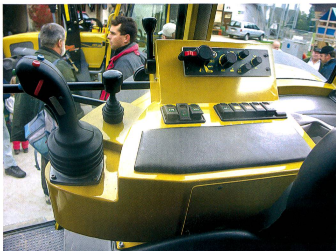
A droite de la console: le joystick, avec boutons pour la marche arrière, le levier de vitesse pour la présélection des plages de vitesses, l'accélération et le choix du mode de circulation de même qu'un affichage clair du réglage de la prise de force et du trois-point.
