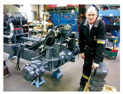
Phase finale de montage du deuxième tracteur. Sepp Knüsel place la transmission avant (conçue par lui-même) dans la bonne position. Reconnaissable, le milieu, le châssis animé (photos U. Zweifel).
