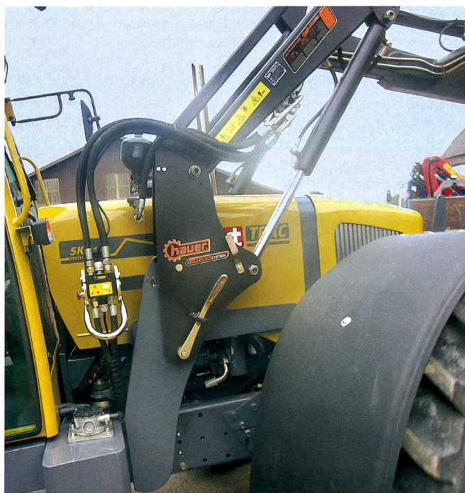
Lien rigide entre les outils frontaux et l'essieu avant de Carraro.
