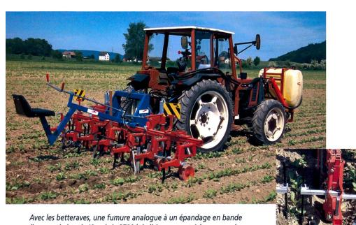
(largeur de bande 10 cm) de 2700 l de lisier concentré (correspond à 40 kg/ha) a été faite en guise de starter. La mise en place de la fumure CULTAN en tant que telle (variantes: 40 kg/ha N et 80 kg/ha à 15 cm de profondeur) a été réalisée à raison d'un espace interligne sur deux au stade 5-6 feuilles, en combinaison avec la sarcleuse à socs.
