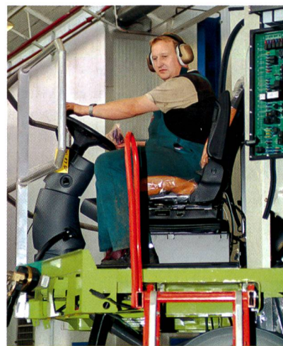
Contrôle d'une batteuse en bout de ligne de montage. L'entreprise consacre de gros moyens à la recherche, au développement mais aussi au suivi qualitatif de ses produits sur l'ensemble de la planète.
