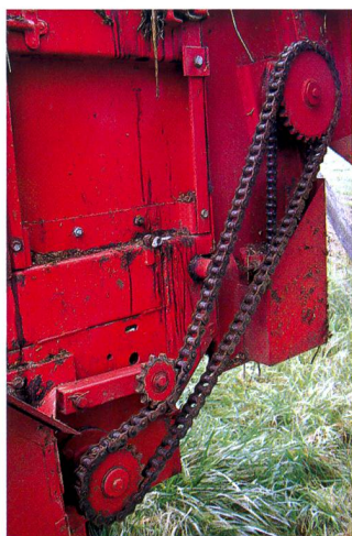
Les chaînes d'entraînement rouillées ou sèches seront trempées dans un bain d'huile à engrenage.
