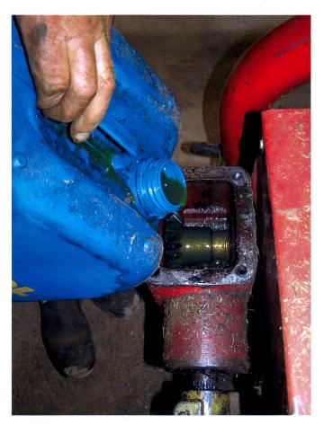
Dans les renvois d'angle légèrement perméables il est possible d'utiliser de la graisse fluide au lieu de l'huile.
