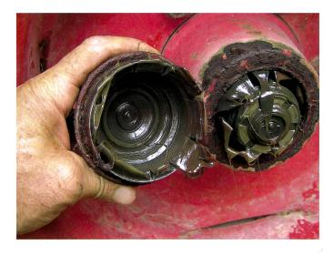
Il faut remplacer la graisse durcie à l'intérieur du moyeu.
