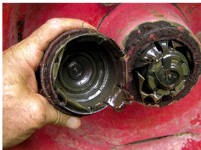
Il faut remplacer la graisse durcie à l'intérieur du moyeu.
