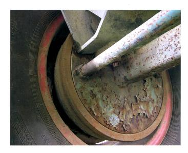
Si le levier de frein est rouillé, contrôler les revêtements de freins.
