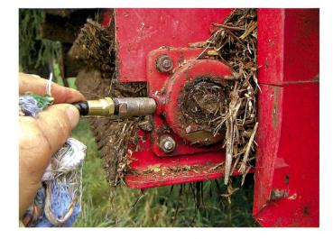
L'eau s'infiltre moins facilement dans les roulements lubrifiés avant le nettoyage.
