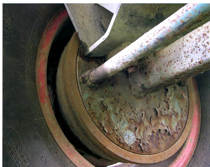
Si le levier de frein est rouillé, contrôler les revêtements de freins.
