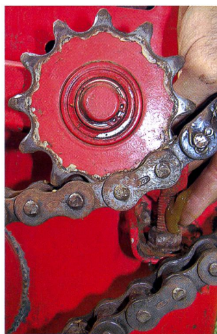
Des filetages graissés sont mieux protégés de la corrosion.
