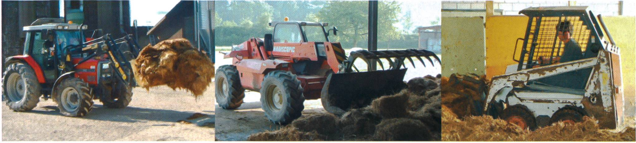
Fig. 10: Suivant les caractéristiques propres à chaque exploitation, il existe différents procédés mobiles pour l'évacuation du fumier dans les étables à litière profonde.
