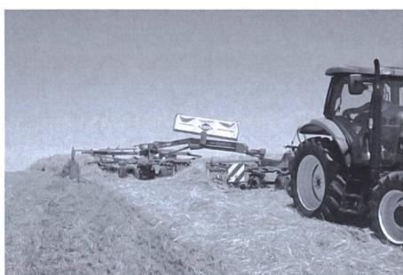
Réglage et repliage hydraulique de la toile à andains pilotés depuis la cabine du tracteur pour le plus grand confort de conduite.
