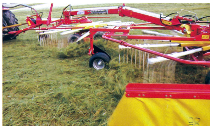
La «Multitast», une roue de jauge qui épargne et met en andain.
