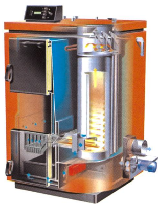
Exemple de chaudière à bûches avec combustion latérale inférieure et chambre de post-combustion verticale (photo: Schmid).
