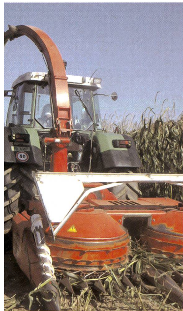
Ensileuse portée Kemper (Ruedi Kröni, Allemagne) à quatre rangs, une option toujours appréciée. La Kemper contribue à rentabiliser le tracteur de grande puissance.
