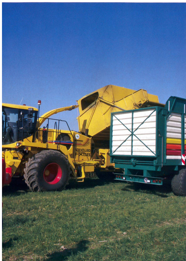
L'ensileuse «Power Mais»: Visible sur la photo, le mulch entre les rangs où seuls les épis sont saisis.
