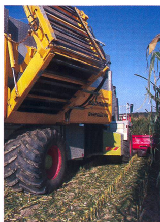
L'ensileuse «Power Mais»: Visible sur la photo, le mulch entre les rangs où seuls les épis sont saisis.
