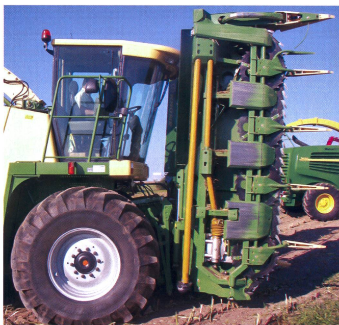
Bec à maïs de l'ensileuse BigX de Krone. Une inclinaison hydraulique amène la hauteur maximale en dessous des 4 mètres autorisés.
