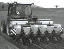
Fig. 4: La herse rotative à axes verticaux équipée d'une tôle de buttage, généralement utilisée dans les cultures maraîchères, a donné des buttes trop meubles, dont la terre n'était pas assez portante pour le semis. Il est recommandé de privilégier les rouleaux plombeurs et un léger semoir monograine mécanique.
