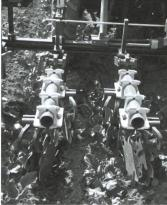
Fig. 2: La sarcleuse-étoile équipée de socs fouilleurs a permis de bien ameublir et retourner le sol et d'éliminer les adventices par buttage (2e et 3e passages).
