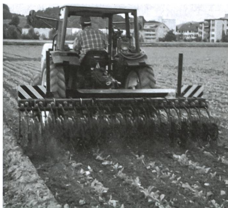
Fig. 3: La sarcleuse-étoile américaine permet de procéder à un sarclage de toute la surface, sans trop endommager les betteraves (stade foliaire 4, montage en biais).
