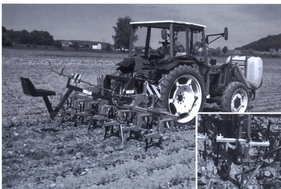
Fig. 6: Avec la fumure CULTAN, le lisier concentré est débité par une pompe puissante via des conduites, des raccords et des tuyaux jusqu'aux trois dents étroites et épandu à 15 cm de profondeur entre les lignes de betteraves.
