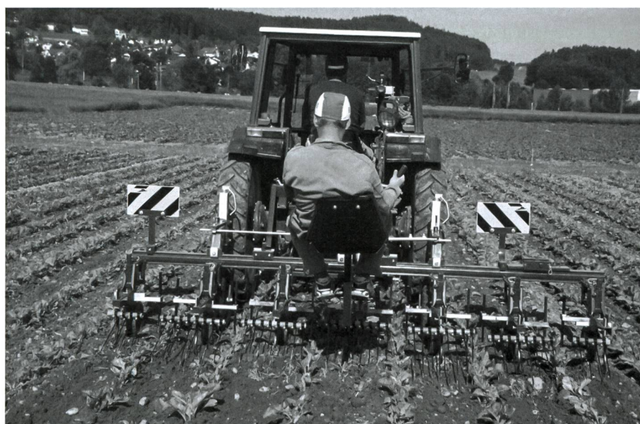
Fig. 1: Le passage de la sarclouse à socs à trois reprises a permis d'obtenir une régulation suffisante des adventices entre les lignes. Les herse portées améliorent les résultats du travail.
