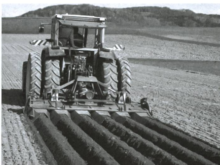
Fig. 4: La herse rotative à axes verticaux équipée d'une tôle de buttage, généralement utilisée dans les cultures maraîchères, a donné des buttes trop meubles, dont la terre n'était pas assez portante pour le semis. Il est recommandé de privilégier les rouleaux plumbeurs et un léger semoir monograine mécanique.
