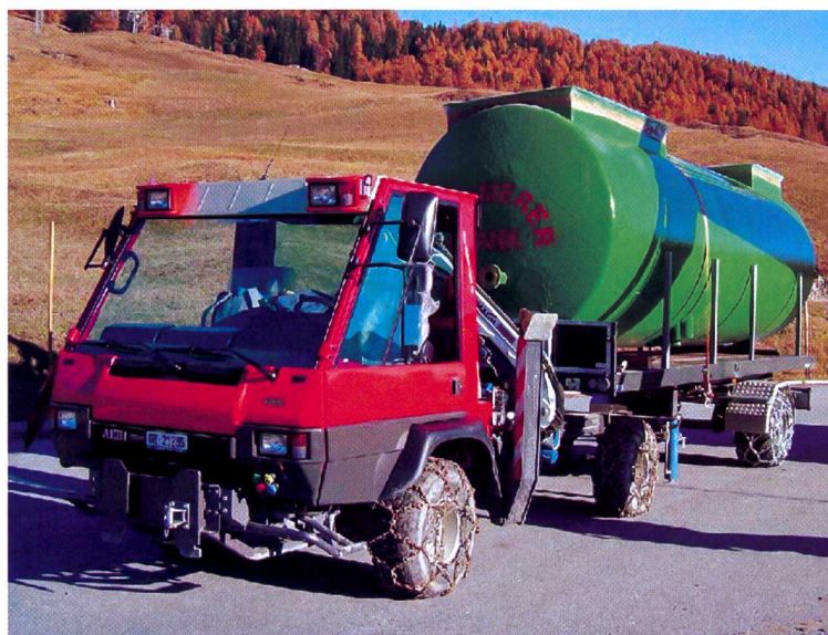
Construction spéciale, fabriquée et montée à Otelfingen: Aebi TP 98 avec support pour grue, attelage Scharmüller K120 et un plateau pour semi-remorque garantissant un poids total de 9 t. (photo P. Meier)
