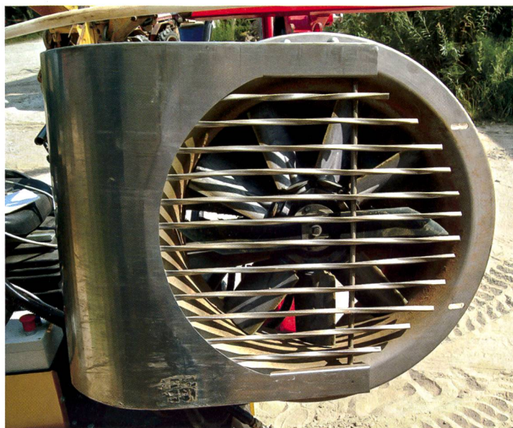
Effeuilleuse classique Ero, d'origine allemande. Le ventilateur aspire et broie à la fois les feuilles de vigne. La grille sert à ménager les grappes et les bois. Avidor a développé une machine disposant d'un tapis mobile qui guide sa machine avec encore plus de précision.
