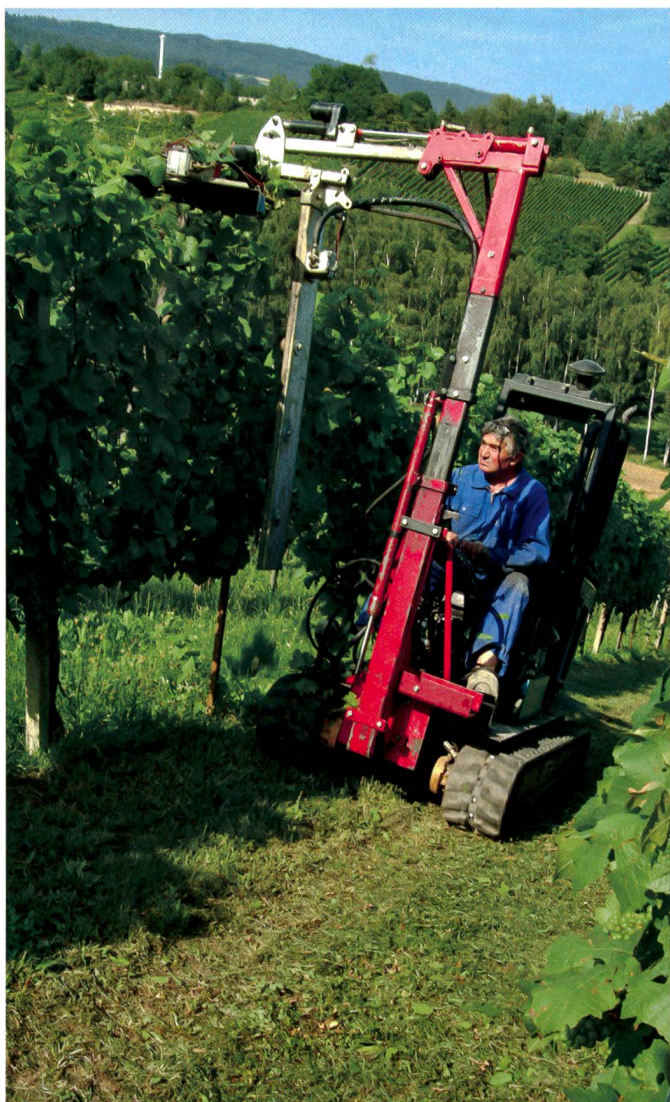
Les Viti-Plus, chenillettes construites par les Loeffel à Boudry, sont d'une exceptionnelle maniabilité. Un engin comme celui de notre illustration développe près de 80 chevaux, en dépit de ses dimensions réduites. L'hydraulique autorise une conduite toute en douceur des chenillettes et un fonctionnement sans à-coup des outils. Poste de conduite d'un Viti-Plus.
