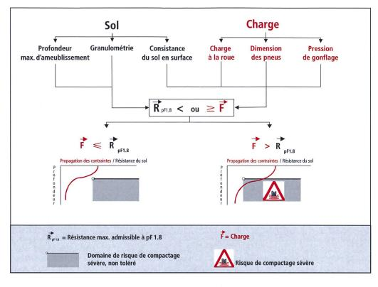
III. 1: Principe de base de l'application. Si la contrainte de charge (F) à la profondeur maximale d'ameublissement est supérieure au seuil critique de résistance du sol (R) à cette profondeur, il y a risque de dommage de tassement.
