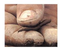
III. 3: Grâce au test tactile, on peut tirer de conclusions directement au champ quant la granulométrie, respectivement au type de sol et à son humidité (photo Telborg)
