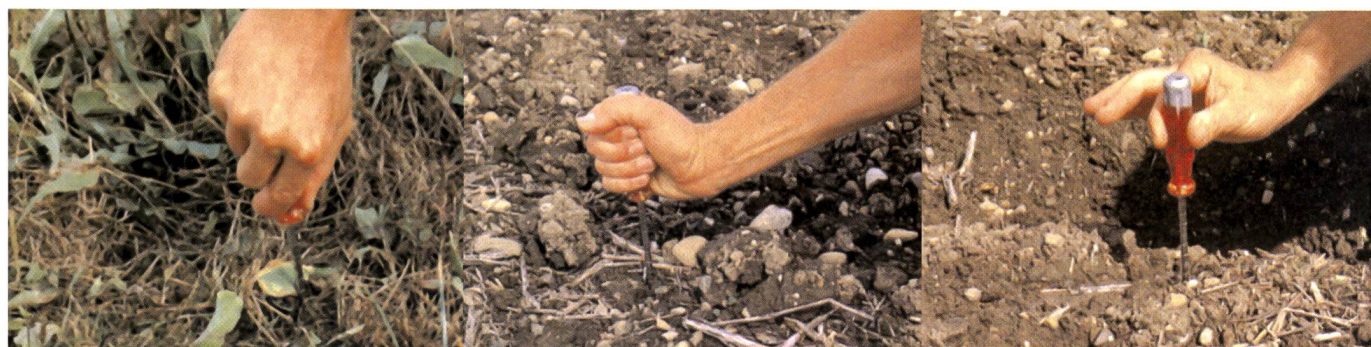
III. 4: Test du tournevis pour une détermination simple de la compacité du sol superficiel: a) dur (> 8 kg de pression), b) mi-dur (5-8 kg de pression), c) mou (jusqu'à 5 kg de pression). Photos: M. Welter
