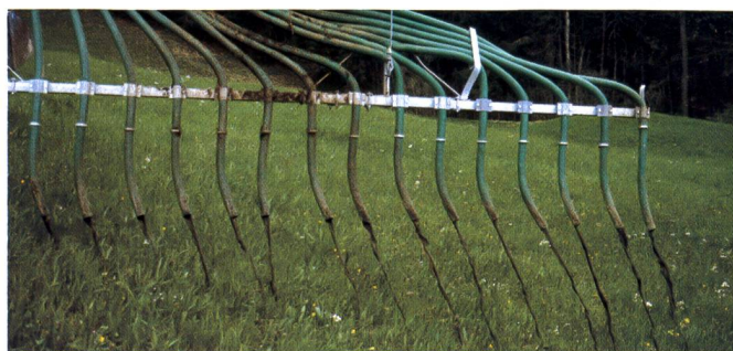
Les répartiteurs à tuyaux tractés sont utilisables également dans les pentes faibles à moyennes, pour autant que le terrain ne soit pas trop fortement parcellisé. La largeur de travail ne devrait pas dépasser 9 m.
