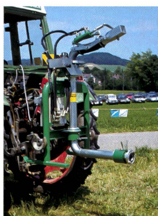
Presque tous les répartiteurs automatiques peuvent être transformés simplement depuis le tracteur en répartiteurs manuels.
