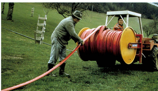
Les dévidoirs permettent un travail propre et rationnel en limitant également les risques de renversement.
