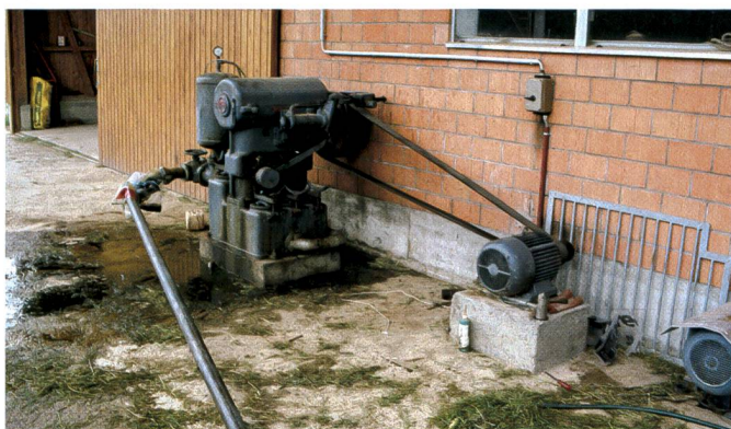
Les anciennes pompes à piston encore en état sont adéquates, particulièrement lorsque la répartition sur le champ se fait manuellement avec la lance ou le répartiteur à main en raison de la forte déclivité.
