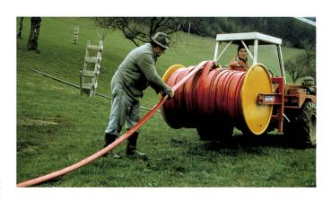
Les dévidoirs permettent un travail propre et rationnel en limitant également les risques de renversement.
