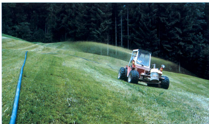
L'épandage par tuyaux permet une fumure en temps voulu avec une dilution importante, remplissant ainsi les exigences d'une mise en valeur du lisier respectueuse de l'environnement.
