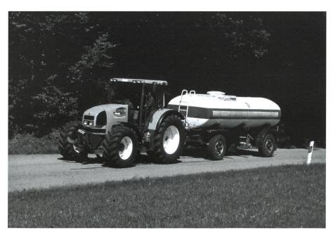
Fig. 1: Une remorque-citerne d'un poids brut de 15 000 kg et d'un poids à vide de 3200 kg sert de charge attelée.
