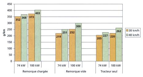
Fig. 8: Consommation moyenne de carburant avec différents chargements.
