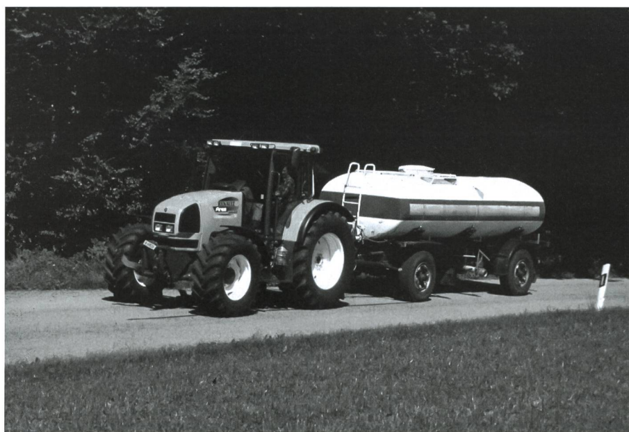
Fig. 1: Une remorque-citerne d'un poids brut de 15 000 kg et d'un poids à vide de 3200 kg sert de charge attelée.
