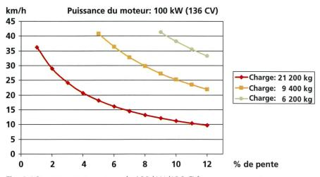
Fig. 6: Vitesse avec un tracteur de 100 kW (136 CV).
