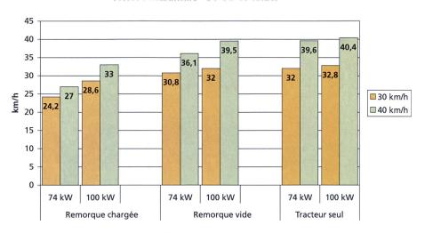
Fig. 7: Vitesse moyenne avec différents chargements.
