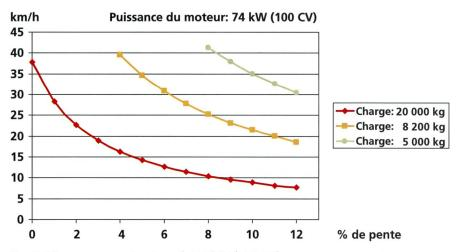
Fig. 5: Vitesse avec un tracteur de 74 kW (100 CV).
