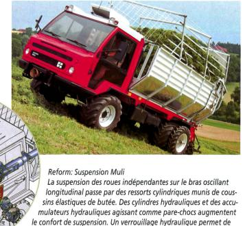
bloquer la suspension lors de travaux en tout-terrain (montés en série sur les modèles 565/575S et en option pour la gamme 8). Photo d'usine.
