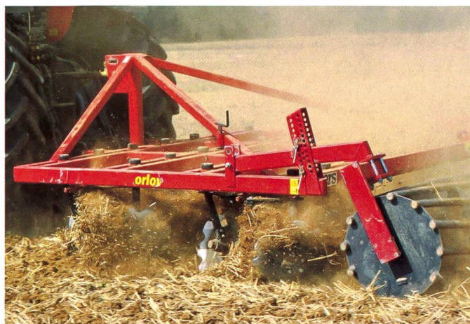
Les outils à disques indépendants se prêtent bien pour le travail superficiel.
