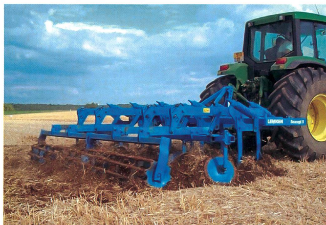
Les cultivateurs sont des outils bon marché. Seuls les socs en patte d'oie permettent de travailler de façon superficielle.
