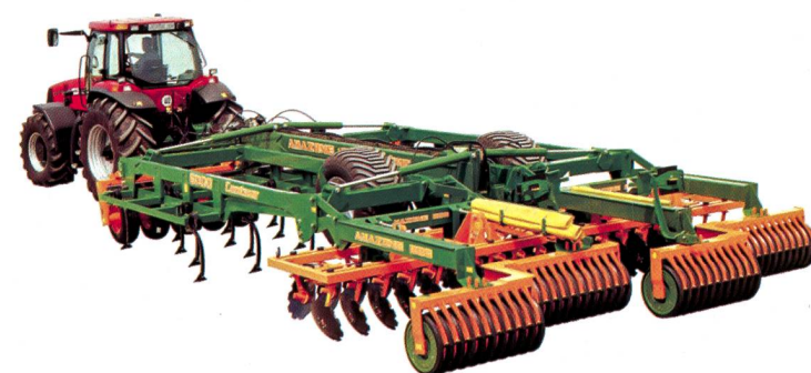
Les combinaisons d'outils permettent d'obtenir une très bonne qualité de travail au détriment de leur poids et de leur prix.
