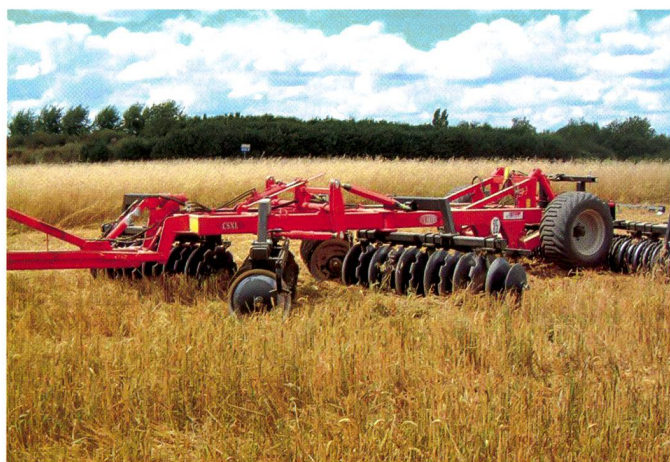
Les cover crop (herse à disques) sont peu sujettes aux bourrages et ont une longue durée de vie.
