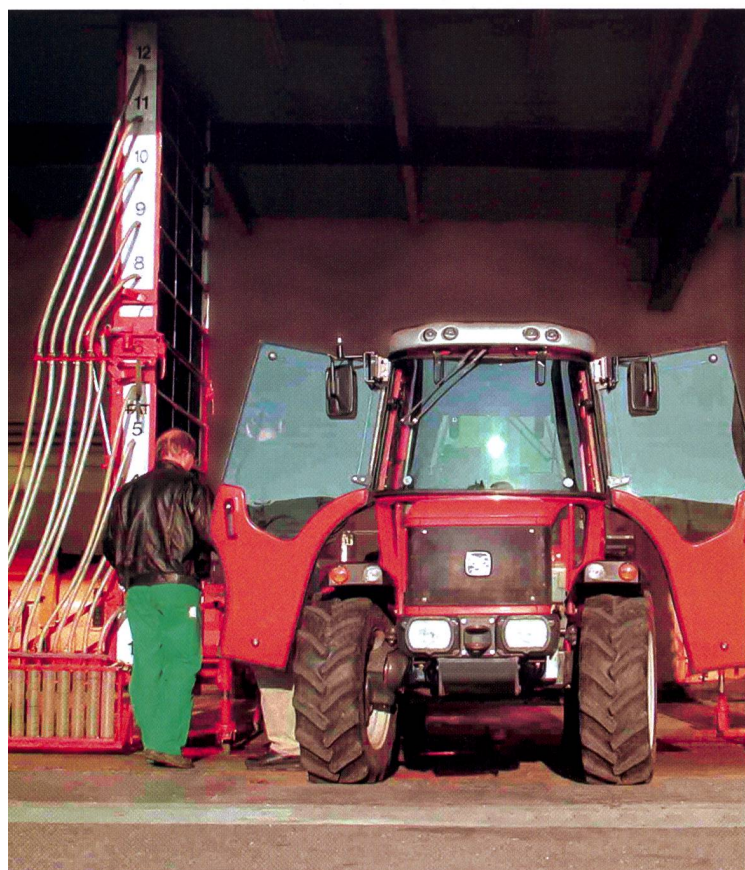
Test de turbodiffuseurs: mesurage de la répartition verticale de l'eau par les deux bancs d'essai de la FAT (photo: Markus Bünther).
