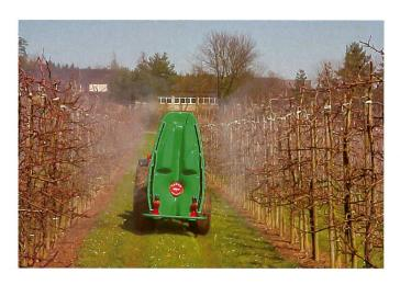
Traitement avec buses à injection lors du débourrement avec un brouillard de goutelettes minime.
