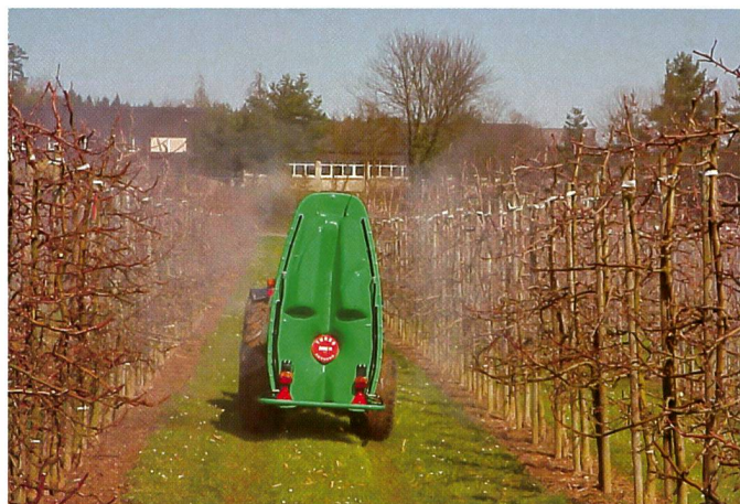
Traitement avec buses à injection lors du débourrement avec un brouillard de gouttelettes minime.
