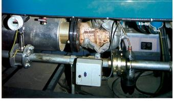
CCF, les détails: au premier plan, en haut, le turbocompresseur pour refroidir l'air de suralimentation. A l'arrière plan, le filtre à particules. La sonde de mesure qui règle l'amenée de biogaz en fonction de sa qualité. A gauche, sous le moteur, une première mondiale: un catalyseur, développé par Hug Engineering, Räterschen, ZH (photo U. Zweifel).
