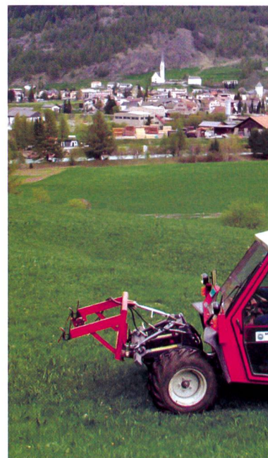
Porte-outils pour les pentes: Technique d'épandage du lisier de Aebi Terratrak en action à Zerneze: le porte-outils a un centre de gravité bas, dispose d'une grande maniabilité grâce à ses quatre roues directrices et ménage la couverture herbeuse avec ses grandes roues à basse pression.
