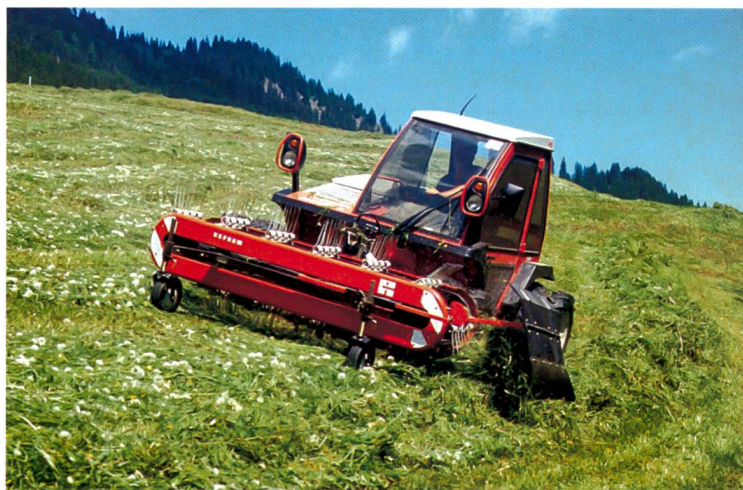
Les faucheuses à deux essieux actuelles (ici la Reform Metrac H7) réalisent les travaux de récolte du fourrage nécessaires jusqu'à une pente de 65%.
