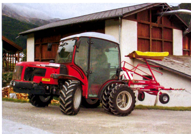
Les tracteurs à poste réversible (ici le Ergit TTR 7400 de A. Carraro) constituent une alternative intéressante aux faucheuses à deux essieux dans les terrains de pente moyenne avec une grande polyvalence d'utilisations, non seulement pour la récolte du fourrage. Illustration: Descente au travail à Santa Maria.
