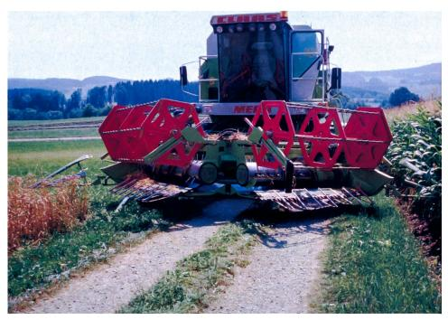
Fig. 18: Le tablier de coupe rabattable hydrauliquement sur la moissonneuse-batteuse permet de réduire le pourcentage de temps de préparation, notamment sur les petites
