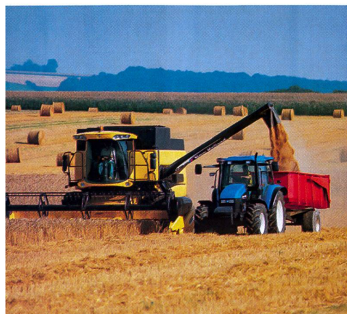
Fig. 10: Dans les petites parcelles dont le sol est humide, il est recommandé de vidanger la trémie dans une remorque à l'arrêt. La vidange dans un véhicule circulant à côté de la moissonneuse augmente la productivité de cette dernière.
