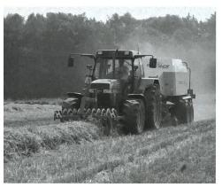
Fig. 13: Les presses à balles rectangulaires doivent être considérées comme des procédés de récolte très performants. Faciles à empiler et idéales pour l'utilisation de l'espace disponible, les balles rectangulaires constituent la base des procédés de transport rationnels.
