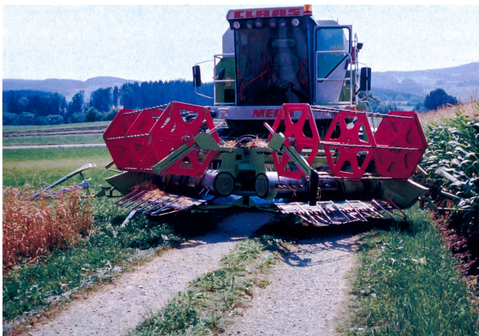
Fig. 18: Le tablier de coupe rabattable hydrauliquement sur la moissonneuse-batteuse permet de réduire le pourcentage de temps de préparation, notamment sur les petites parcelles.
