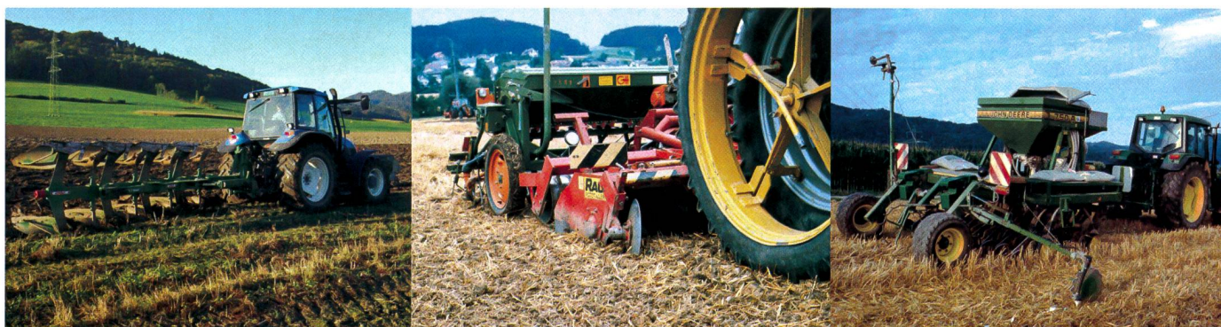
Fig. 1: Différents procédés de travail du sol et de semis (labour, combinaison d'outils, semis direct) permettent de laisser tomber certaines phases et donc d'économiser du temps de travail.
