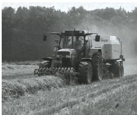
Fig. 13: Les presses à balles rectangulaires doivent être considérées comme des procédés de récolte très performants. Faciles à empiler et idéales pour l'utilisation de l'espace disponible, les balles rectangulaires constituent la base des procédés de transport rationnels.
