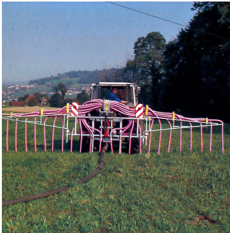
Avec la rampe d'épandage à tuyaux souples, le lisier est épandu directement en petites bandes sur le sol. Ainsi, beaucoup moins de \text{NH}_3 s'évapore dans l'air.
