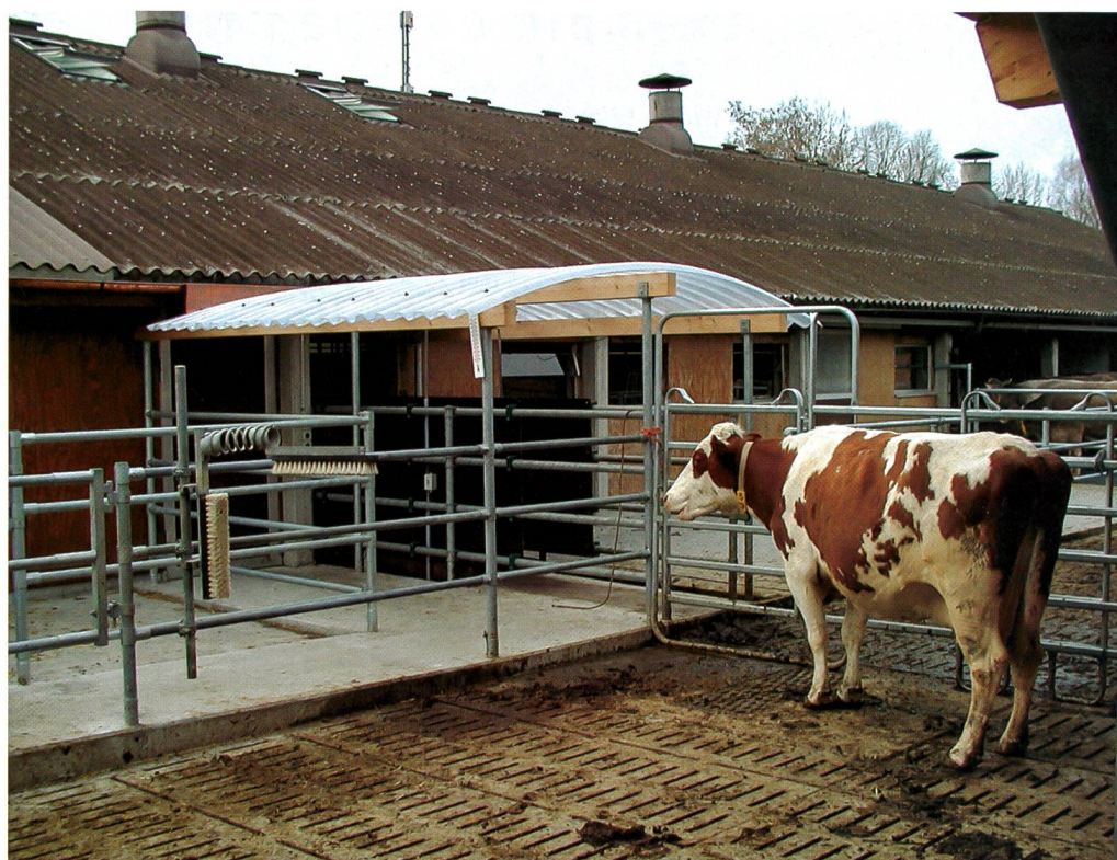
Comme l'urine est évacuée plus vite avec les caillebotis, les pertes de \text{NH}_3 sont inférieures à celles des sols non perforés. (Photo: Rheinhof, Salez)
