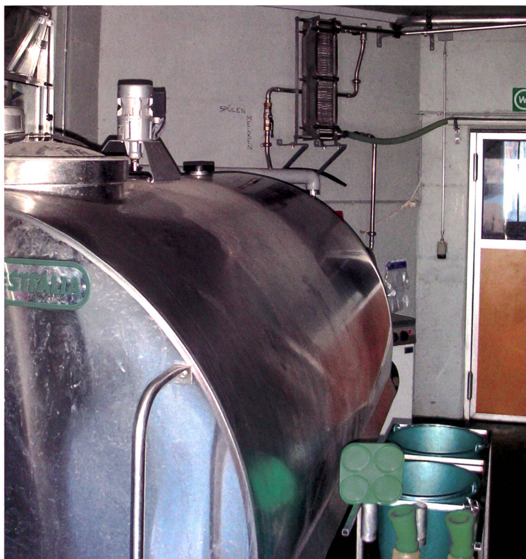
Refroidissement par détente directe: la vanne d'expansion thermostatique règle la température juste sous le point de congélation, ce qui favorise un refroidissement rapide sans formation de glace.
