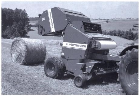
Fig. 2: Presse à balles rondes en action. Le préfanage et une vitesse appropriée lors du pressage permettent d'obtenir des balles d'ensilage de forme régulière (photo référencée: Pöttinger).
