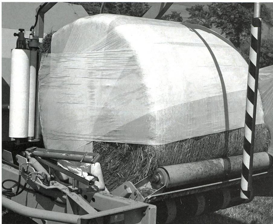
Fig. 7: L'enrubanneuse pose plus de couches de film sur la face plane des balles que sur la face arrondie (photo référencée: Claas)
