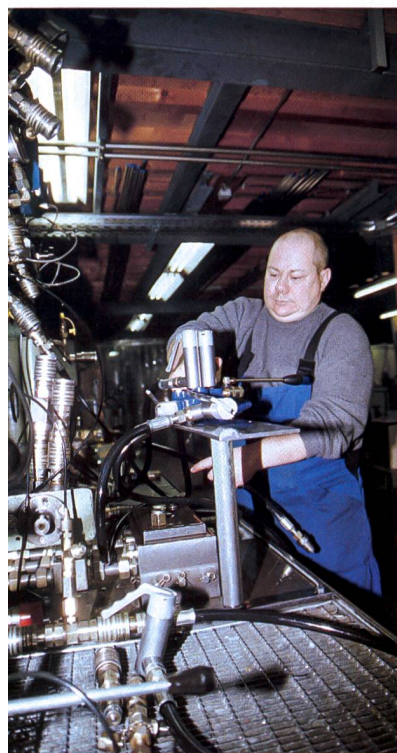
Plus les pressions de service sur les armatures hydrauliques sont élevées, plus les cycles de contrôle sur les bancs d'essai de l'entreprise sont importants.
