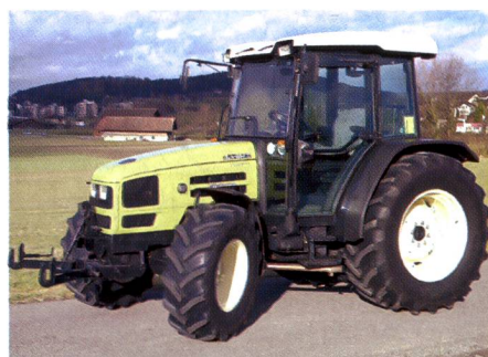
Fig. 8: Tracteur HÜRLIMANN XA 658, moteur turbo quatre cylindres, 61 kW (83 CV), transmission à 3 paliers de charge, hydraulique et prise de force frontales, poids 3300 kg (prix catalogue: CHF 79 400.-), rapport de test n° 1837/02
