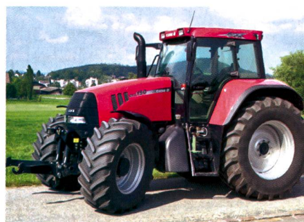
Fig. 3: Tracteur CASE IH CVX 150, moteur turbo six cylindres, 107 kW (145 CV), transmission en continu à trois plages de vitesse, hydraulique frontale, suspension avant, suspension de la cabine, poids 7150 kg (prix catalogue: CHF 162 600.-), rapport de test n° 1844/02.
