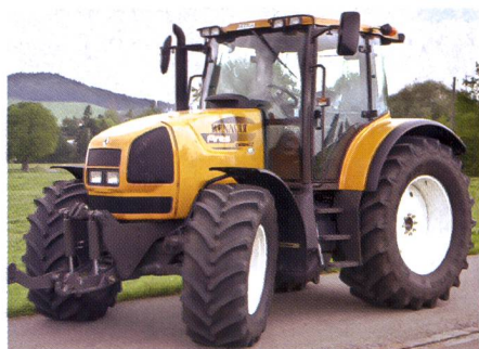
Fig. 4: Tracteur RENAULT Ares 696 RZ, moteur turbo six cylindres, 104 kW (140 CV), transmission à 4 paliers de charge, hydraulique frontale, suspension avant, suspension de la cabine, poids 6400 kg (prix catalogue: CHF 126 423.-), rapport de test n° 1834/02.
