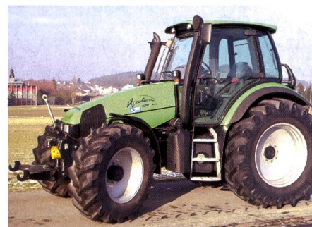
Fig. 5: Tracteur DEUTZ-FAHR Agroton 120 MK3, moteur turbo six cylindres, 92 kW (125 CV), transmission à 4 paliers de charge, hydraulique et prise de force frontales, suspension avant, poids 6280 kg (prix catalogue: CHF 124 700.-), rapport de test n° 1836/02.
