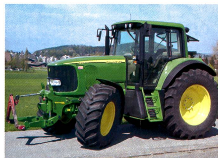
Fig. 2: Tracteur JOHN DEERE 6920 AutoPowr, moteur turbo six cylindres, refroidissement d'air de suralimentation, 110 kW (150 CV), transmission en continu, hydraulique et prise de force frontales, suspension avant, suspension de la cabine, poids 6840 kg (prix catalogue: CHF 171 850.-), rapport de test n° 1843/02.
