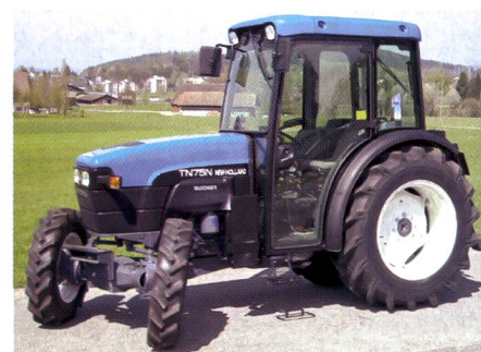
Fig. 9: Tracteur étroit NEW HOLLAND TN75 N, moteur turbo trois cylindres, 53 kW (72 CV), transmission à 2 paliers de charge, essieu avant SuperSteer, poids 2530 kg (prix catalogue: CHF 66 280.-), rapport de test n° 1838/02.
