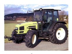
Fig. 8: Tracteur HÜRLIMANN XA 658, moteur turbo quatre cylindres, 61 kW (83 CV), transmission à 3 paliers de charge, hydraulique et prise de force frontales, poids 3300 kg (prix catalogue: CHF 79 400.-), rapport de test nº 1837/02
