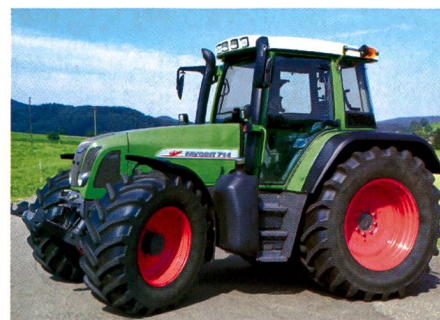
Fig. 1: Tracteur FENDT Favorit 714 Vario, moteur turbo six cylindres, quatre soupapes et refroidissement d'air de suralimentation, 103 kW (140 CV), transmission en continu à deux plages de vitesse, hydraulique et prise de force frontales, suspension avant, suspension de la cabine, poids 6500 kg (prix catalogue: CHF 170 388.-), rapport de test n° 1829/01.
