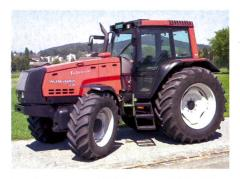
Fig. 6: Tracteur VALTRA VALMET 8350-4 HiTech, moteur turbo six cylindres, 99 kW (135 CV), transmission à 3 paliers de charge, suspension avant, poids 5720 kg (prix catalogue: CHF 120 200.-), rapport de test nº 1830/01.
