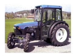
Fig. 9: Tracteur étroit NEW HOLLAND TN75 N, moteur turbo trois cylindres, 53 kW (72 CV), transmission à 2 paliers de charge, essieu avant SuperSteer, poids 2530 kg (prix catalogue: CHF 66 280.-), rapport de test nº 1838/02.
