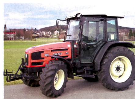
Fig. 7: Tracteur SAME Dorado 75, moteur à aspiration quatre cylindres, 53 kW (72 CV), transmission à 3 paliers de charge, hydraulique et prise de force frontales, poids 3110 kg (prix catalogue: CHF 73 100.-), rapport de test n° 1835/02.
