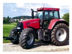
Fig. 3: Tracteur CASE IH CVX 150, moteur turbo six cylindres, 107 kW (145 CV), transmission en continu à trois plages de vitesse, hydraulique frontale, suspension avant, suspension de la cabine, poids 7150 kg (prix catalogue: CHF 162 600.-), rapport de test nº 1844/02.
