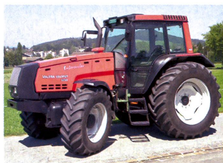
Fig. 6 : Tracteur VALTRA VALMET 8350-4 HiTech, moteur turbo six cylindres, 99 kW (135 CV), transmission à 3 paliers de charge, suspension avant, poids 5720 kg (prix catalogue: CHF 120 200.-), rapport de test n° 1830/01.
