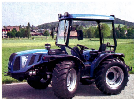
Fig. 10: Tracteur réversible BCS Vithar 900 MT, moteur turbo quatre cylindres, 61 kW (83 CV), transmission réversible synchronisée, poids 2050 kg (prix catalogue: CHF 66 497.-), rapport de test n° 1842/02.
