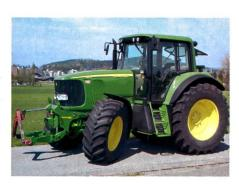
Fig. 2: Tracteur JOHN DEERE 6920 AutoPowr, moteur turbo six cylindres, refroidissement d'air de suralimentation, 110 kW (150 CV), transmission en continu, hydraulique et prise de force frontales, suspension avant, suspension de la cabine, poids 6840 kg (prix catalogue: CHF 171 850.-), rapport de test nº 1843/02.
