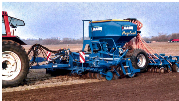
Rabe: la MegaSeed est un semoir en ligne pour le semis normal, sous litière ou même direct. Les outils de travail vus depuis le tracteur: disques pour mulch, raffermissement (derrière la roue de soutien), disques ouvreurs, agrégats de semis, roues plumbeuses, étrille.
