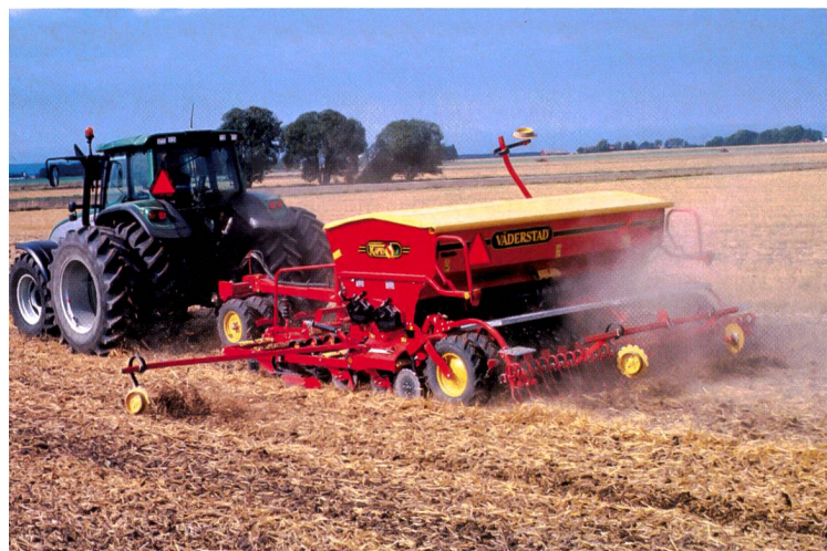
Väderstad: les combinaisons de semis Rapid sont si maniables qu'elles s'adaptent parfaitement aux petites parcelles. Tous les semoirs sont montés sur des machines de travail du sol tractées. La pression nécessaire pour le semis direct ou sous litière s'obtient ainsi sans problème.
