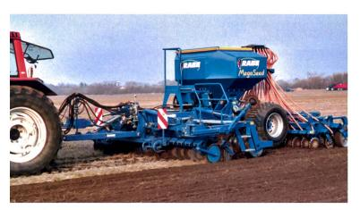
Rabe: la MegaSeed est un semoir en ligne pour le semis normal, sous litière ou même direct. Les outils de travail vus depuis le tracteur: disgues pour mulch, raffermissement (derrière la roue de soutien), disques ouvreurs, agrégats de semis, roues plombeuses, étrille.
