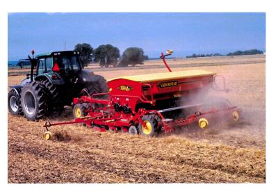
Väderstad: les combinaisons de semis Rapid sont si maniables qu'elles s'adaptent parfaitement aux petites parcelles. Tous les semoirs sont montés sur des machines de travail du sol tractées. La pression nécessaire pour le semis direct ou sous litière s'obtient ainsi sans problème.
