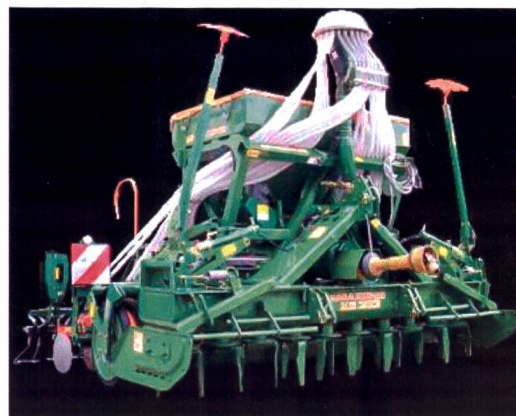
Amazone: semoir pour semis sur labour et combinaisons de semis avec herse rotative ou chisel. Il est possible d'équiper les organes de semis de socs tractés WS ou de socs roulants RoTeC pour semis sous litière.
