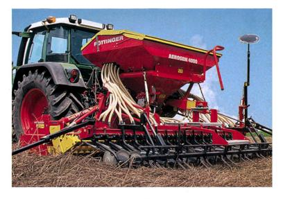
Pöttinger Aerosem 4000: dans les bonnes parcelles avec exploitation intensive, les rendements en céréales élevés entraînent une forte production de paille. Les socs à disque travaillent sans bourrage.
