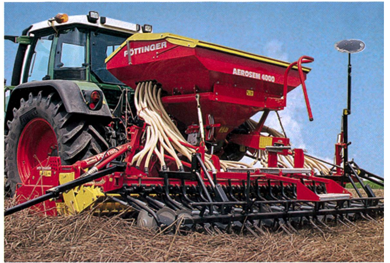
Pöttinger Aerosem 4000: dans les bonnes parcelles avec exploitation intensive, les rendements en céréales élevés entraînent une forte production de paille. Les socs à disque travaillent sans bourrage.
