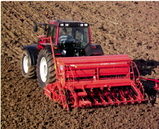
Kuhn-Integra: semoir porté Integra avec relevage hydraulique des socs et déplacement hydraulique du centre de gravité vers le tracteur pendant les trajets routiers. Il est possible d'équiper la plupart des semoirs de socs à disques qui permettent un semis sous litière sans poser de problème.
