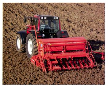
Kuhn-Integra: semoir porté Integra avec relevage hydraulique des socs et déplacement hydraulique du centre de gravité vers le tracteur pendant les trajets routiers. Il est possible d'équiper la plupart des semoir de socs à disques qui permettent un semis sous litière sans poser de problème.
