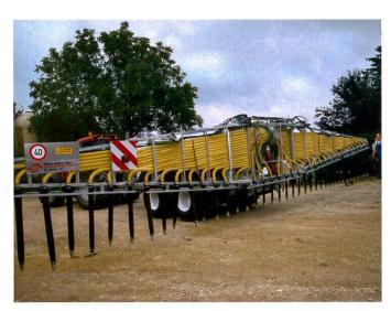
Une signalisation parfaite ne gêne pas du tout l'épandage. On remarquera ici le dispositif anti-goutte que les fabricants proposent sous diverses versions.
