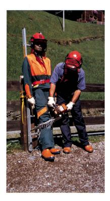
Démonstration de protection efficace d'un pantalon avec une sécurité anti-coupure.
