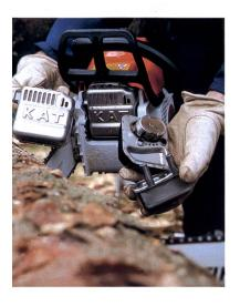
Efficacité élevée des catalyseurs: protoxyde d'azote, hydrocarbure -40%; teneur en particules -50%; consommation de carburant -30%; puissance +40%.
