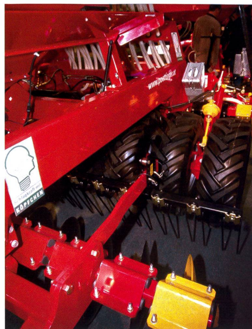
Packer à pneus: simultanément train roulant et dispositif de compactage (Pöttinger).
