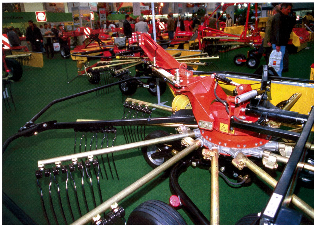
Enormes performances à la superficie: andaineur et faneur de grandes dimensions pour le dispositif d'attelage pendulaire du tracteur (Fella).
