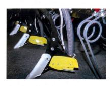
Soc à dents rigides avec dispositif coulissant en matière synthétique: semoir pneumatique avec fumure sous le lit de semences (Horsch).
