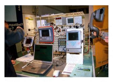
La communauté de travail ISOBUS de la DLG et de l'association de technique agricole VDMA a développé le test ISOBUS afin de vérifier l'échange d'informations entre les appareils de différents constructeurs. Le certificat ISOBUS-TEST de la communauté de travail distingue les tracteurs et les machines compatibles entre eux.
