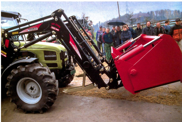
Atteler et dételer le chargeur frontal sans descendre du véhicule.
