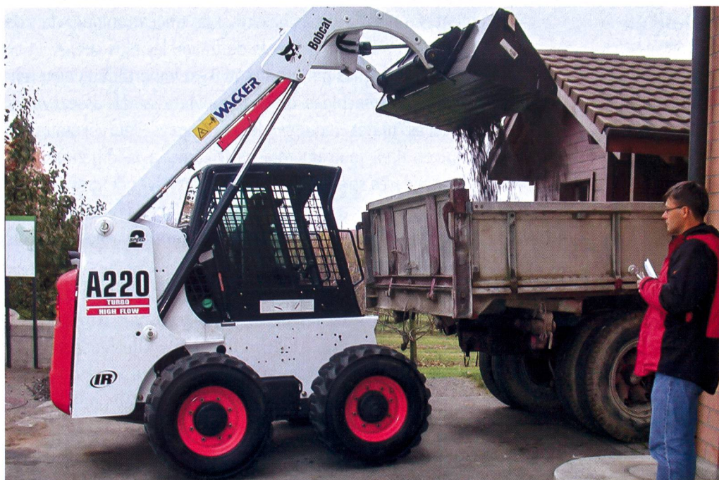
Chargeur compact, traction sur toutes les roues, direction «Panzer»: excellente maniabilité. Willi Gut a présenté les véhicules avec beaucoup de sens pratique (photo: Josef Scherrer, BauernZeitung).
