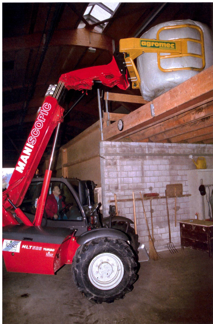
Chargeur télescopique: toujours pas dépassé en termes de sécurité, de portée au déversement et de maniabilité.
