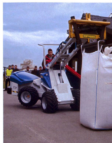
Le risque de renversement en soulevant de lourdes charges est toujours présent. Le chargeur articulé CSF Jolly (série SL) dispose d'une barre dans le tube central pour stabiliser la hauteur du châssis.
