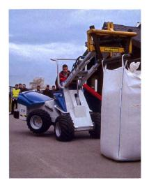
Le risque de renversement en soulevant de lourdes charges est toujours présent. Le chargeur articulé CSF Jolly (série SL) dispose d'une barre dans le tube central pour stabiliser la hauteur du châssis.
