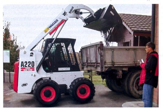
Chargeur compact, traction sur toutes les roues, direction «Panzer»: excellente maniabilité.
