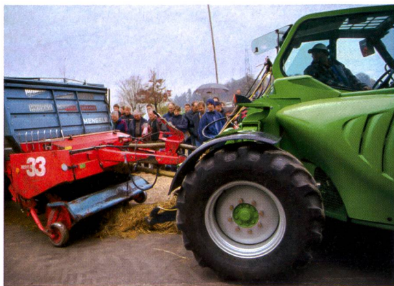
Merlo: un véhicule tracteur polyvalent avec l'hydraulique aux trois points et prise de force...
