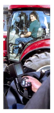
Vue du Steyr Profi sur son frère jumeau, le Case MXU 135. Au premier plan, les attributs de la marque: le «Multicontroler», confortable et bien disposé, est intégré à l'accoudoir. A l'arrièreplan, un détail commun: les parois vitrées et bombées de la cabine ménagent un espace confortable au passager.
