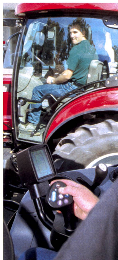
Vue du Steyr Profi sur son frère jumeau, le Case MXU 135. Au premier plan, les attributs de la marque: le «Multicontroler», confortable et bien disposé, est intégré à l'accoudoir. A l'arrière-plan, un détail commun: les parois vitrées et bombées de la cabine ménagent un espace confortable au passager.
