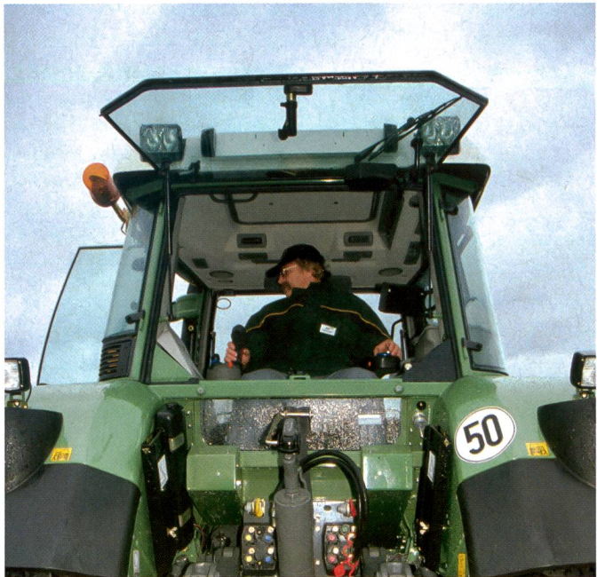
Marche arrière intégrée: A droite, le joystick; à gauche, le mini-volant.
