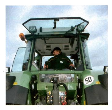
Marche arrière intégrée: A droite, le joystick; à gauche, le mini-volant.
