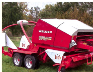
Welger RP 220 Double Action, avec double bras d'enrubannage
