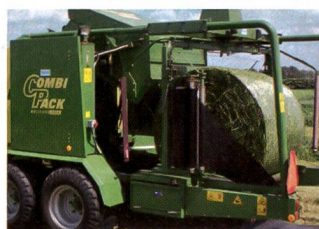
Krone Combi Pack 1500 V MC, variable avec dispositif de coupe Multicut.
