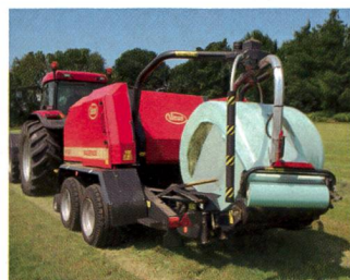
Vicon RV 160, presse à chambre variable avec densité de pressage progressive.
