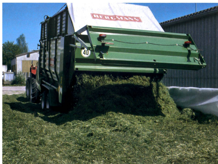
Les remorques d'ensilage modernes à grand volume, avec rotor de chargement, doseur et commande-confort répondent à l'exploitation de machines en commun et impliquent un degré d'utilisation élevé.
